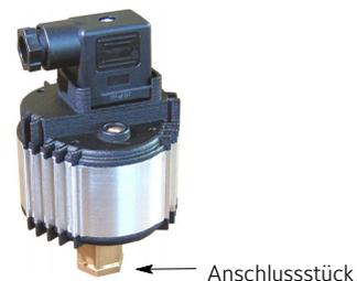
Bei einer Montage von Hand kann sich das Gehäuse relativ zum Anschlussstück verdrehen. Dadurch wird der Drehzahlregler nicht beschädigt, aber der werkseitig eingestellte Sollwert kann sich verschieben.
