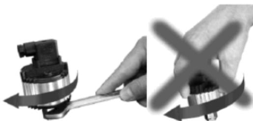
Verwenden Sie immer einen Maulschlüssel der Schlüsselweite 19, um den Drehzahlregler festzuziehen.
